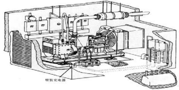
度于正常工作范围。应确保排风口净面积最小不低于散热器芯有效面积的 1.25 倍，排风口中心位置应尽可能与机组散热器芯中心位置一致，排风口的宽高比也尽可能与散热器芯的宽高比相同。
